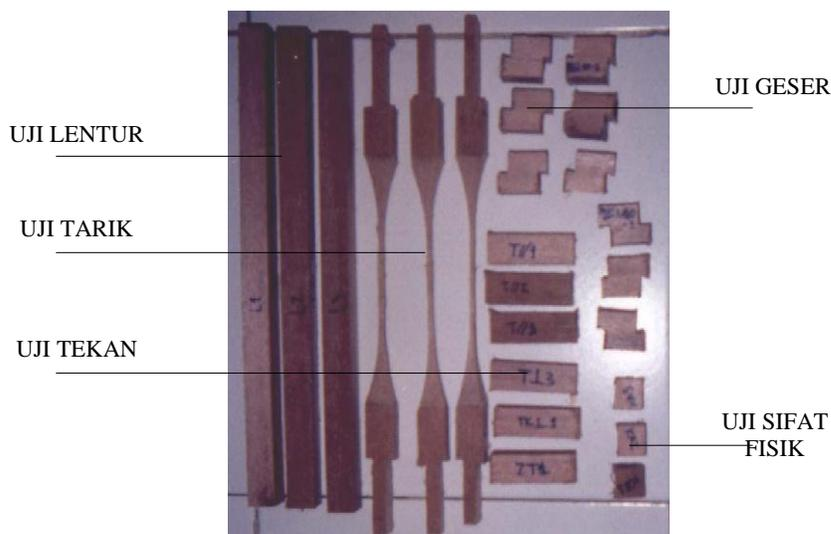
Gambar 1. Ragam pengujian fisik dan mekanik kayu kamper
